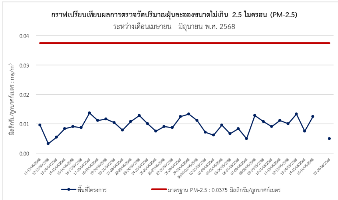
รูปที่ 4-3 กราฟเปรียบเทียบผลการตรวจวัดปริมาณฝุ่นละอองขนาดเล็กไม่เกิน 2.5 ไมครอน (PM-2.5) เฉลี่ย 24 ชั่วโมง
