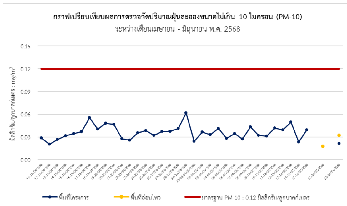
รูปที่ 4-2 กราฟเปรียบเทียบผลการตรวจวัดปริมาณฝุ่นละอองขนาดเล็กไม่เกิน 10 ไมครอน (PM-10) เฉลี่ย 24 ชั่วโมง
