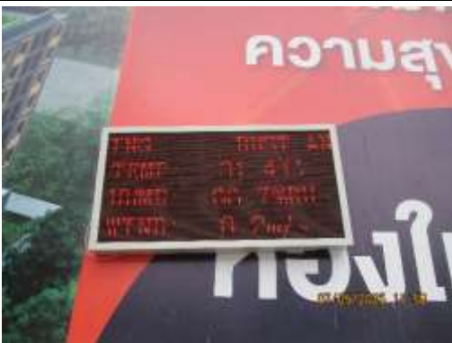
รูปที่ 9 เครื่องตรวจวัดคุณภาพอากาศเป็นเรียลไทม์
